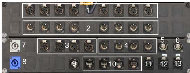
Auf der Rückseite des Multiplexgenerators sind alle erforderlichen Anschlüsse auf einem Patchfeld aufgelegt.
